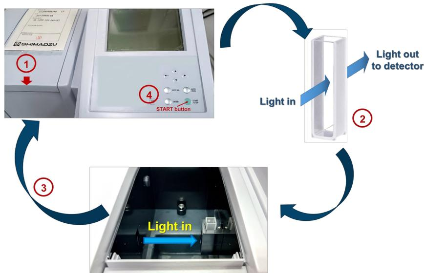
分光光度計測量吸光度的使用示意圖：(1) 打開蓋子，將裝有樣品的比色管放入槽中，(2) 將比色管的透明面朝向光路徑(3) 關閉蓋子，然後(4) 按下開始鈕"START" 測量吸光度 (*Abs*)。
