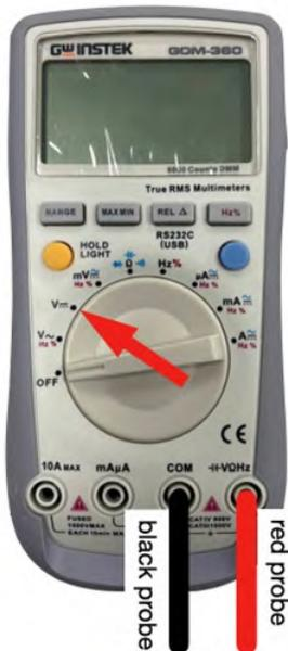
圖 P-3顯示本次測量中使用的萬用電表以及探針位置和檔位選擇。
